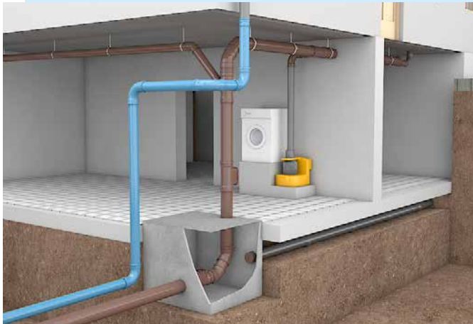
Abhängen neuer Leitungen im Kellerbereich
